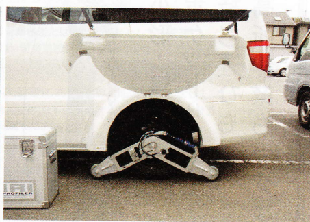
左はIRI測定車。右は測定車の後輪に設置したIRI測定装置（写真：大日コンサルタント）
